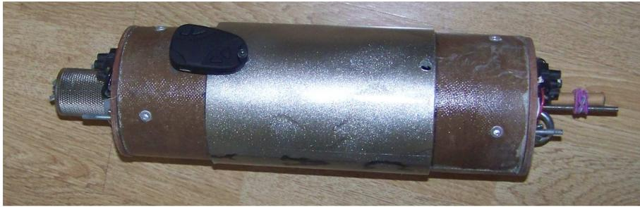
Dans mes fusées j'utilise des interrupteurs à vis pour allumer mes altimètres donc le trou pour atteindre la vis est également utilisé pour les échanges de pression.
